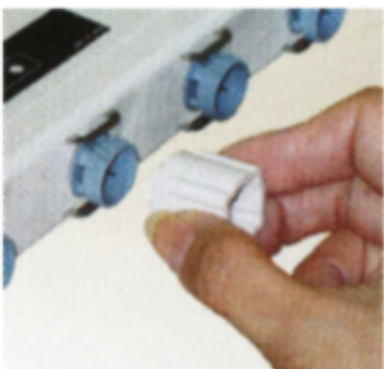
更换放电针示意图
