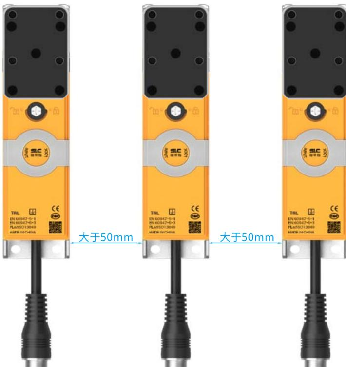
使用多个TRL1安全门锁时, 可能出现相互干扰而导致TRL1安全门锁发生误动作。为防止相互干扰, 请按如下规定安装TRL1安全门锁。
